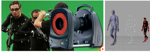
FIGURE 3.3 – Capture de mouvements avec marqueurs passifs Vicon( à gauche), actifs Visualeyez( à droite) [22]
