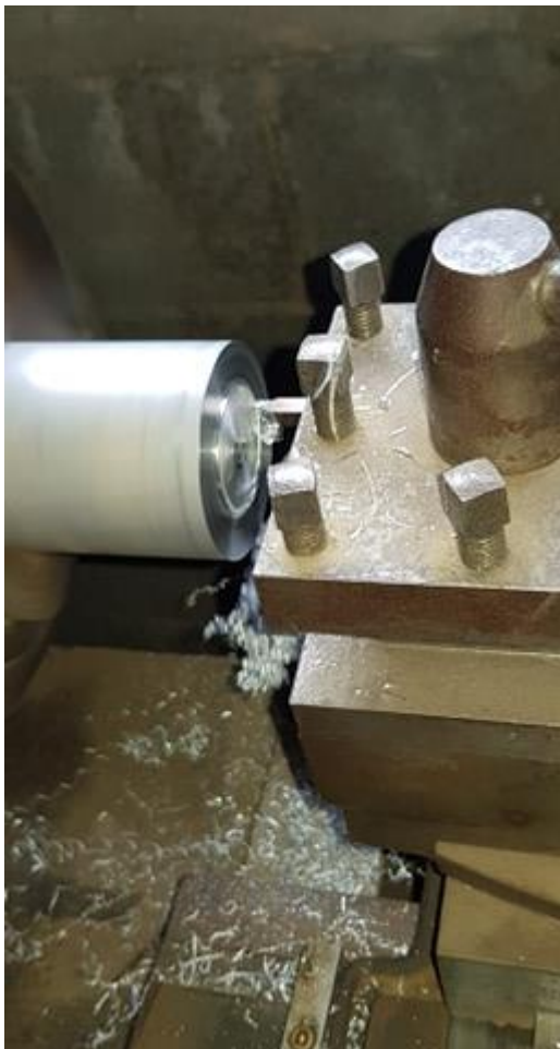
Figure 25 : Photos de la fabrication des disques
